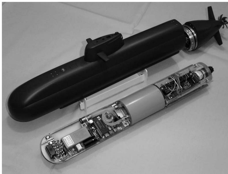
Im Heck werkeln 4 Becker Servos S-100. 4-mal Signale und 2-mal Stromversorgung werden vom Heck zum Vorderteil mit 6 vergoldeten Federkontakten auf einer geätzten, vergoldeten Platine im "Steckverfahren" beim Zusammenbau mit dem Bajonettverschluss hergestellt. Somit gibt es keinen Kabelsalat, keine dicken Stecker usw..
