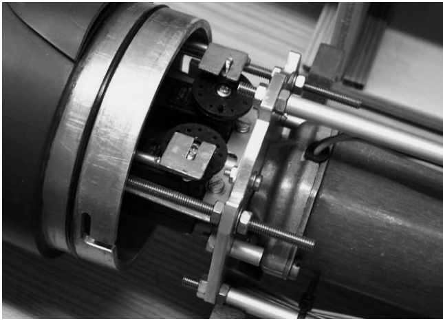
Ruderanlenkung und Eigenbaubajonett
