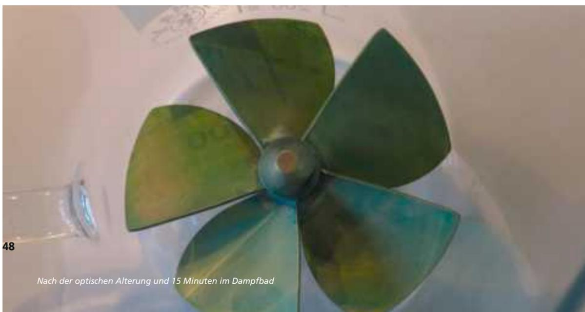
Nach der optischen Alterung und 15 Minuten im Dampfbad
