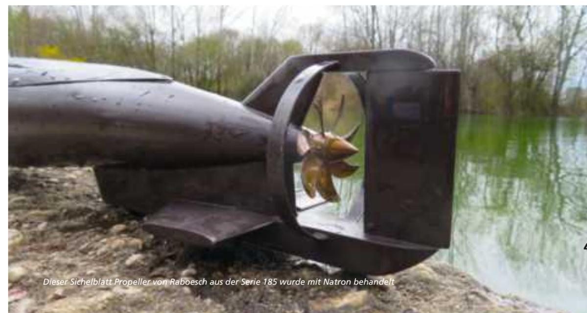
Dieser Sichelblatt-Propeller von Raboesch aus der Serie 185 wurde mit Natron behandelt
